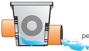
POZZETTO CON SCARICO A ZERO: permette il deflusso dell'acqua impedendone il ristagno.
